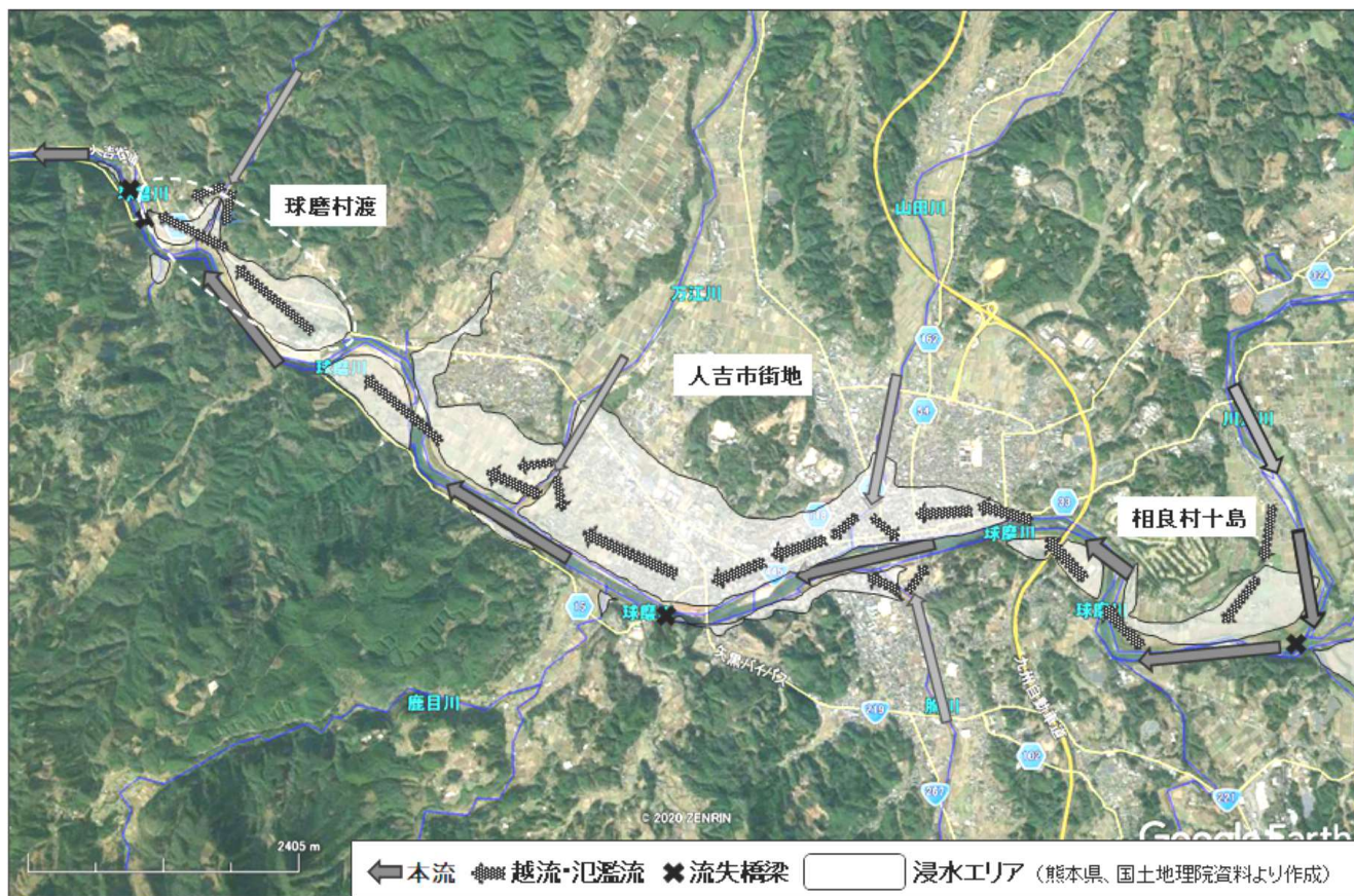
図3. 球磨川水系大水害時の球磨川等越流・氾濫状況（推定）図（球磨村渡～人吉市～相良村）
